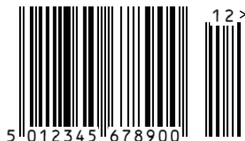
Rysunek 5.2.2.3.5.1 – 2 Symbol kodu kreskowego EAN-13 z dwucyfrowym symbolem add-on
