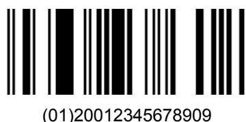
Rysunek 5.1 – 4 Symbol kodu kreskowego GS1 DataBar Wielokierunkowego
