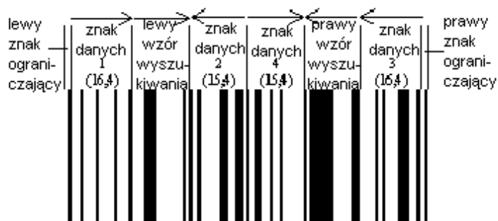
Rysunek 5.6.1.2 – 1 Struktura GS1 DataBar
