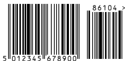
Rysunek 5.2.2.3.5.2 – 2 Symbol kodu kreskowego EAN-13 z pięciocyfrowym symbolem add-on
