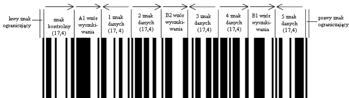
Rysunek 5.6.1.4 - 1 Struktura GS1 DataBar Rozszerzony
