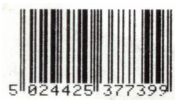
Rysunek 5.5.3.3.12 – 1 Symbol z problemem w określeniu krawędzi
