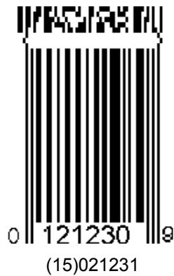
Rysunek 5.8.8 – 4 Symbol UPC-E z dwukolumnowym CC-A
