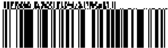
Rysunek 5.8.8 - 8 Symbol GS1 DataBar Rozszerzony z czterokolumnowym CC-A
