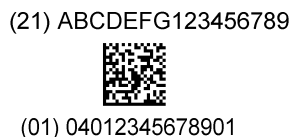
Rysunek 5.1 – 6 Symbol kodu kreskowego GS1 DataMatrix
