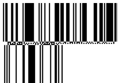
Rysunek A1.3 - 1 Przykład łączenia danych z zastosowaniem symboliki GS1 DataBar Rozszerzonej Spiętrzonej
