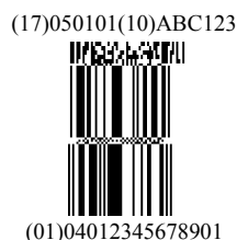
Rysunek 5.1 – 5 Symbol kodu kreskowego GS1 DataBar Spiętrzony Wielokierunkowy z elementem złożonym
