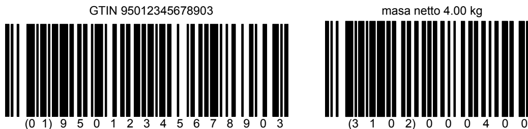
Rysunek A.1.2 – 1 Kodowanie danych w dwóch symbolikach GS1 -128
