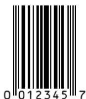
Rysunek 5.2.2.3.4 - 1 Symbol kodu kreskowego UPC-E (kodujący 00123400057 poprzez pominięcie zer)
