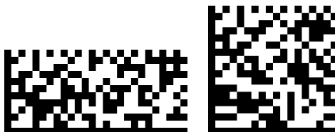
Rysunek 5.7.3.1 - 1 Prostokątne i kwadratowe symbole GS1 DataMatrix
