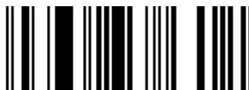
Rysunek 5.6.1.2.1 – 1 Symbol kodu kreskowego GS1 DataBar Wielokierunkowy
