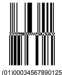
Rysunek 5.6.1.2.4 - 1 Symbol kodu kreskowego GS1 DataBar Spiętrzony Wielokierunkowy
