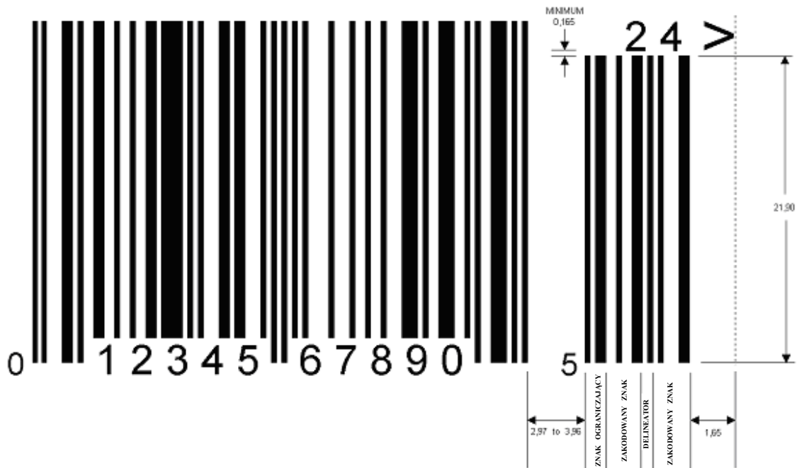
Rysunek 5.2.4.6 - 6 Symbol kodu kreskowego UPC-A z dwucyfrowym symbolem add-on
