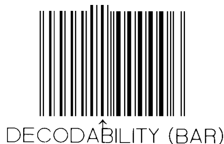
Rysunek 5.5.3.3.12 - 3 Symbol kalibracji z zaaranżowaną niską oceną dekodowalności
