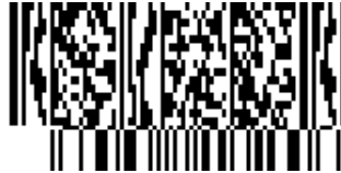
Rysunek 5.8.8 - 7 Symbol GS1 DataBar Ograniczony z trzykolumnowym CC-B
