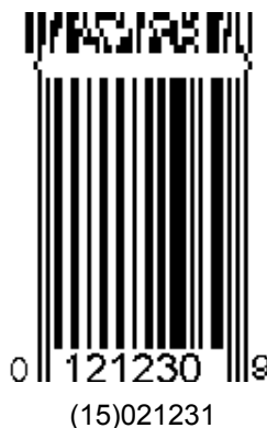
Rysunek A1.3 - 2 Przykład połączenie symbolik kodów GS1 (GTIN- zakodowany w UPC-E, data "Best before" w symbolice kompozytowej)
