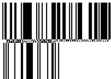
Rysunek 5.6.1.4.2 – 1 Symbol kodu kreskowego GS1 DataBar Rozszerzony Spiętrzony
