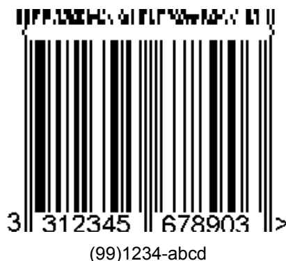
Rysunek 5.8.8 - 1 Symbol EAN-13 z czterokolumnowym elementem CC-A
