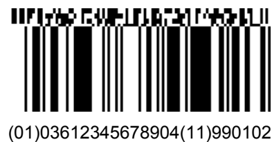
Rysunek 5.8.8 – 5 Symbol GS1 DataBar-14 z czterokolumnowym CC-A
