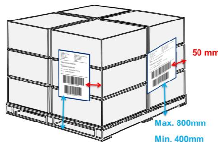
RYS. 3. Lokalizacja etykiety logistycznej GS1 na paletcie – krańcowe położenia.
