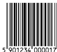
Rysunek 1 Oznaczenie kodowe na wyrobie detalicznym: numer GTIN-13 w kodzie EAN-13
