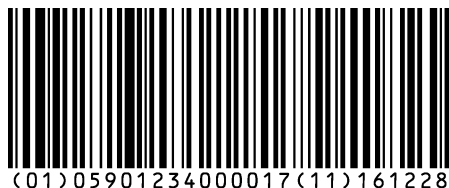
Rysunek 2 Oznaczenie kodowe na wyrobie niedetalicznym w kodzie GS1-128 bez numeru NSN
